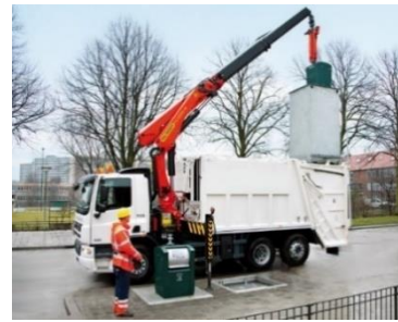
Фото. Завантаження контейнерів підземного розташування
