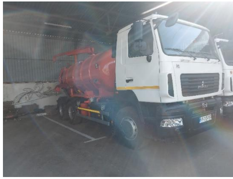
Фото. Вакуумна машина для перевезення рідких відходів місткістю цистерни 10 м 3
