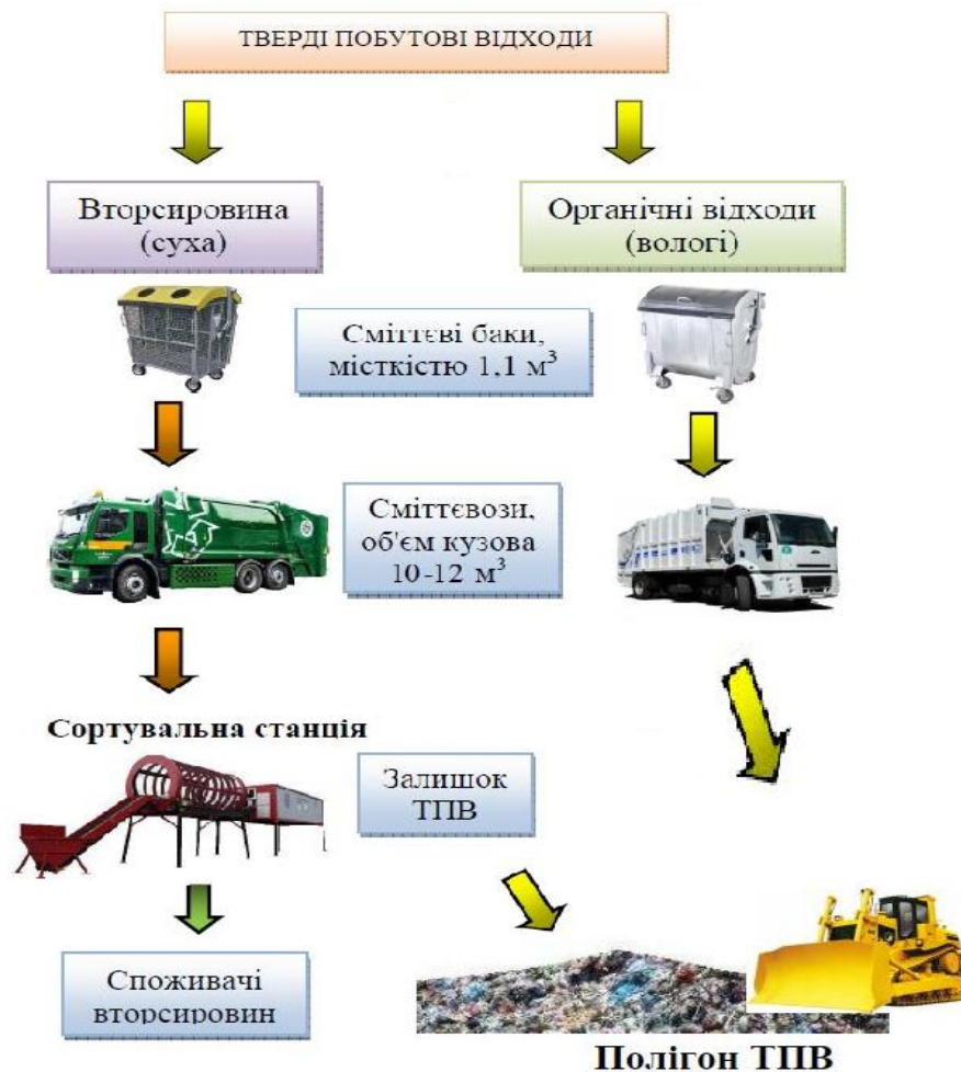
Рис. 2.6 Схема сортування ТПВ на 2 потоки
