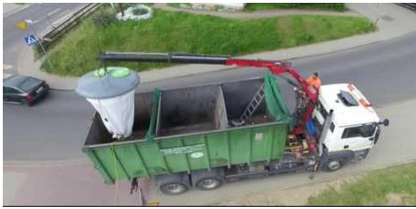
Фото. Завантаження контейнерів підземного розташування
